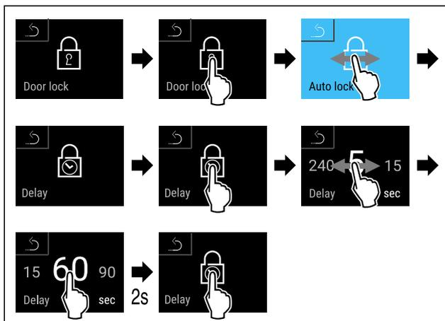
Fig. 92 Folgende Werte sind einstellbar: 5, 15, 60, 90, 120, 180 und 240 Sekunden
