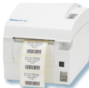
Ausdruck von Barcode-Etiketten mit dem MELAprint 60
