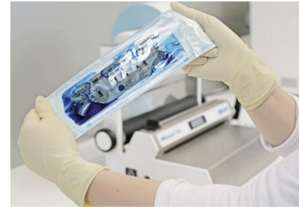
Der Tintentest **MELAcontrol Ink Test** ist ein zuverlässiges Prüfmittel zur **wöchentlichen** Kontrolle der Siegelnähte auf Dichtigkeit gemäß DIN EN ISO 11607-1 und ASTM F1929-12.
